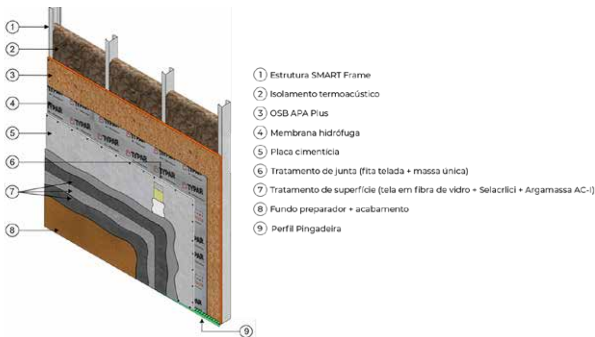
Figura 10 — Exemplo do sistema com chapa cimentícia
